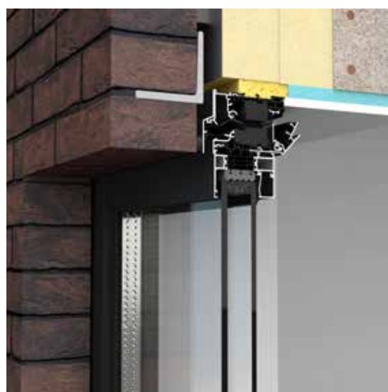
Volledig achter slag - buiten
